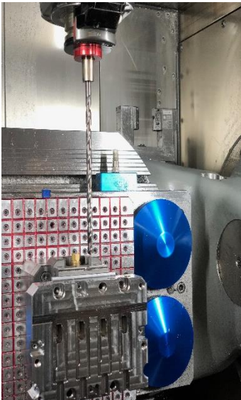
Image: Drilling process „Mediumverteiler“ without water
