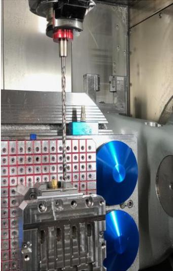
**Bild: Bohrprozess Mediumverteiler ohne Wasser**
