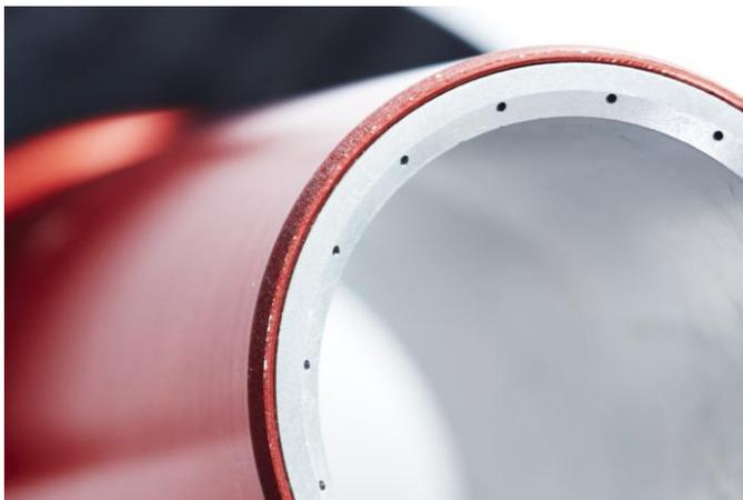
**Bild: Düse, feine Schräg-Bohrungen von 0,5mm sorgen für einen konstanten Luftstrahl und eine hohe Strömungsgeschwindigkeit**
