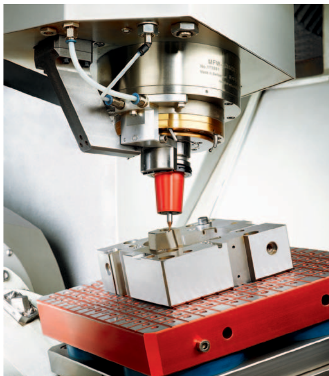
Ein Druckluftsystem entfernt Späne beim Fräsen dauerhaft, zuverlässig und rückstandslos von Schneide und Werkstück.
