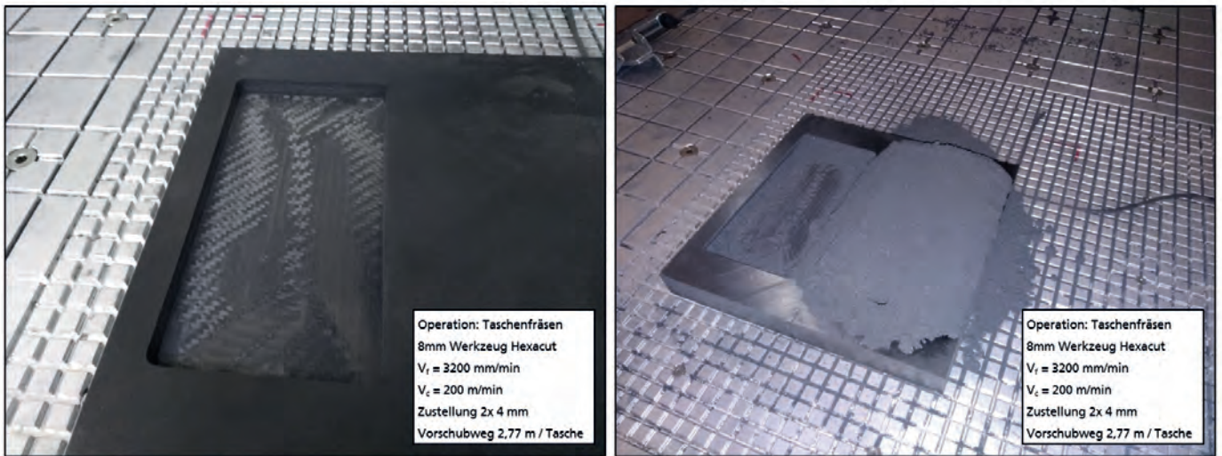
Bild 3: Taschenfräsen mit (links) und ohne Mediumverteiler (rechts).
