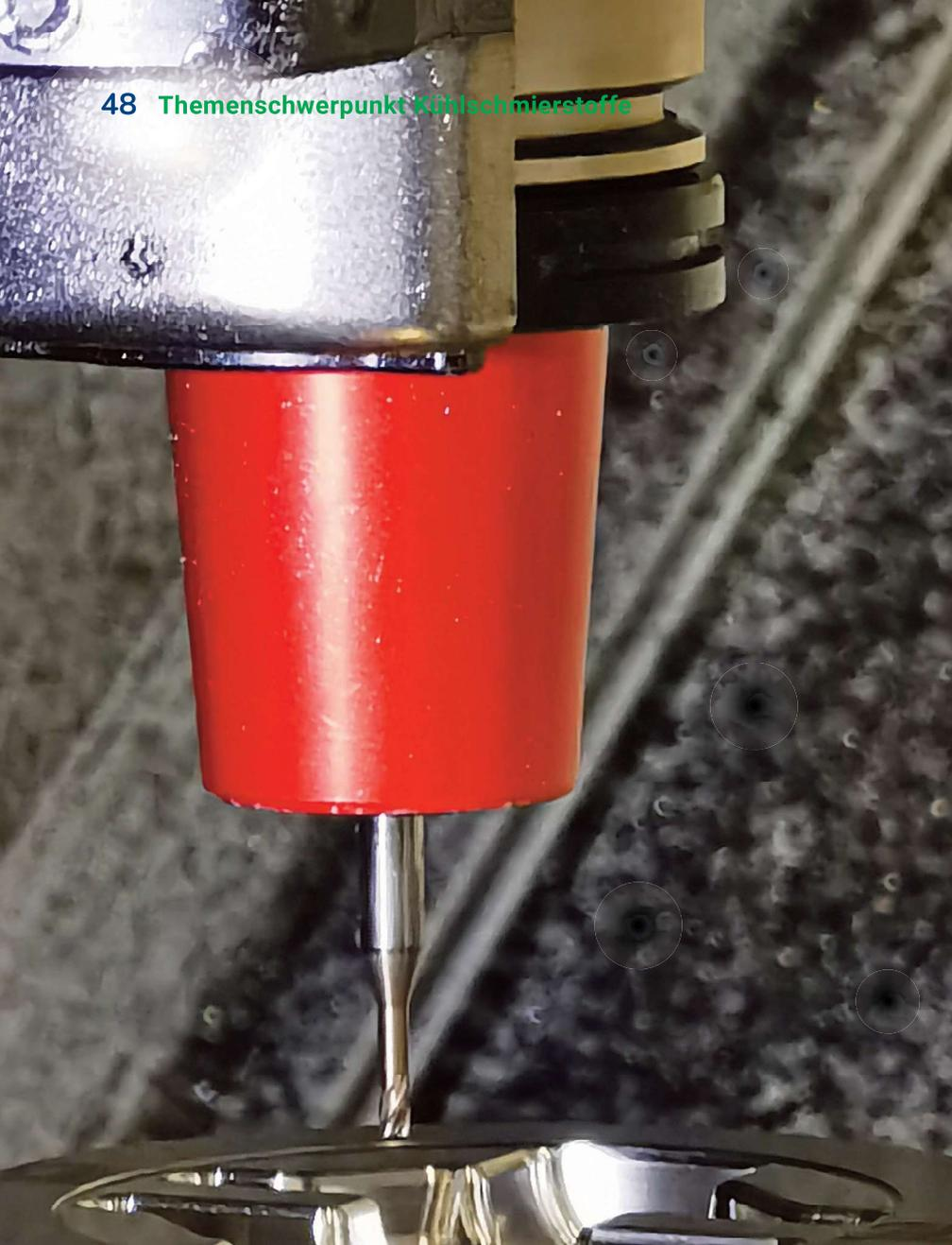
Bei der Hartbearbeitung erfolgt die Schmierstoffversorgung durch MHT-Mediumverteiler.
