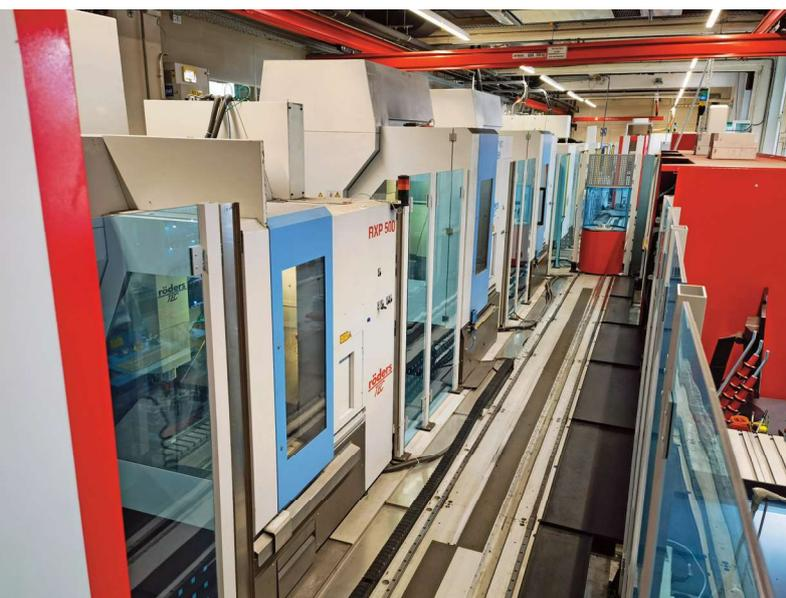
In der getakteten ZF-Fertigungslinie für das Hartfräsen stehen vier Röders-Fräsbearbeitungszentren sowie eine Koordinatenmessmaschine – im Hintergrund ist die Schleuse zur Funkenerosionslinie zu sehen.
