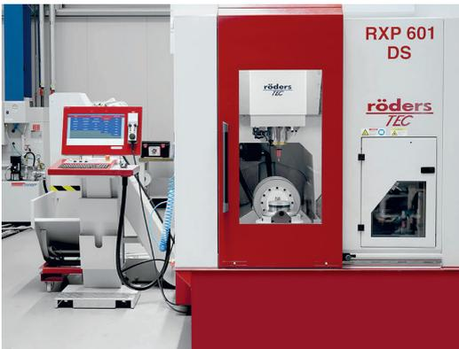
Das Bauteil wurde auf der Röders RXP 601 DS - ausgestattet mit Merz Mediumverteiler - gefräst.
