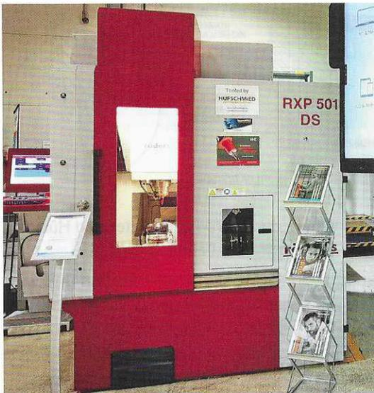
Der Demonstrator wurde im Technikum von Hufschmied auf dieser fünfachsigem Röders RXP 501 DS gefräst. Die Anlage ist mit dem MHT-Mediumverteiler ausgestattet (Bild: Klaus Vollrath)
