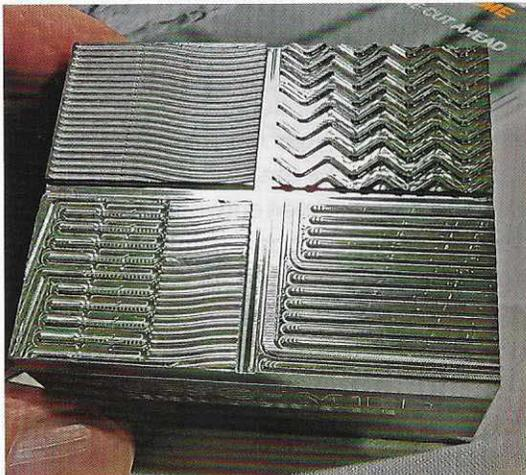
Probewerkstück (50 mm x 40 mm) mit verschiedenen für Bipolarplatten typischen Oberflächenstrukturen aus dem Böhler-Werkstoff K888 Matrix mit 63+1 HRC (Bild: Klaus Vollrath)
