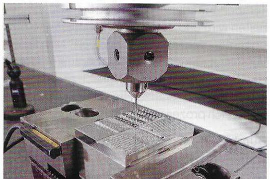
Taktile Messung des Demonstrators auf der bei Röders vorhandenen Koordinaten-Messmaschine Zeiss Xenos (Bild: Röders)
